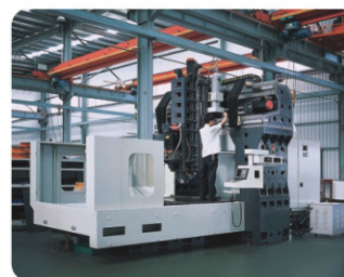
龍門加工中心出廠前調試
